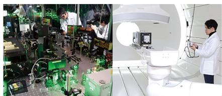
レーザー駆動イオン加速手法を用いた小型重粒子線がん治療装置の開発
